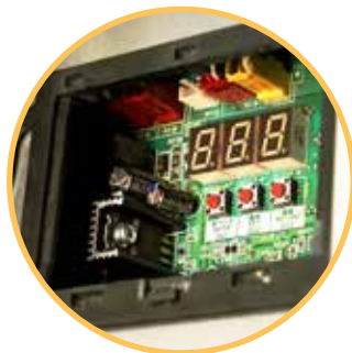
Display met 3 cijfers en 7 segmenten
